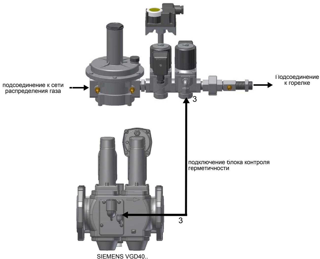
Ниже приводятся процедуры монтажа клапанных групп, используемых на разных рампях.
