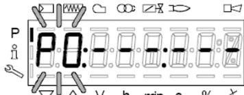
Нажать "F" и "+" для увеличения угла открытия сервопривода топлива "OF" до желаемого значения (например 8° - см. ниже) для точки розжига или "F" и "-" - для уменьшения угла
