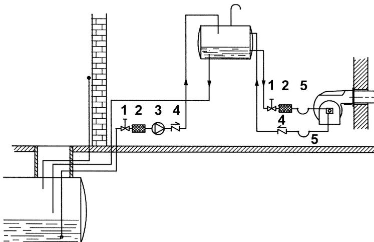
Рис. 12- - Кольцевой контур подачи топлива
