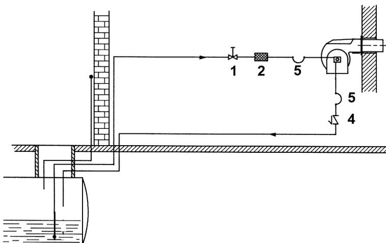
ПРИМЕЧАНИЕ: в системах с гравитационной или с кольцевым контуром подачи жидкого топлива, установить автоматическое отсечное устройство.
