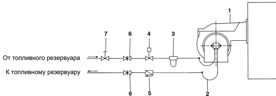
Рис. 14 - Двухтрубная система
