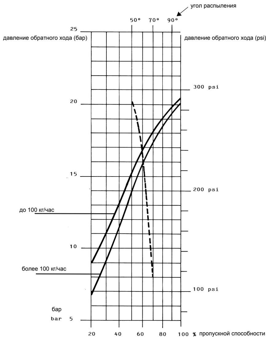
**ДАВЛЕНИЕ ТОПЛИВА НА ФОРСУНКЕ = 25 бар**
