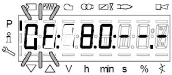
Если необходимо ввести угол открытия воздушной заслонки "0A" в точке розжига (например 5° - см. ниже) нажать "A" и одновременно "+" или "-":)
